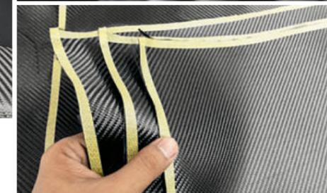
Le fibre di carbonio sono estremamente resistenti e si caratterizzano per un'elevata rigidità. Vengono prima filate, poi intrecciate e infine incorporate in una matrice plastica.
