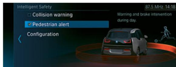
L'equipaggiamento **Driving Assistant Plus**<sup>1,3,\*</sup> migliora notevolmente le condizioni di sicurezza e il comfort. Include l'Avvertimento di presenza pedoni e rischio di tamponamento con frenata d'emergenza City, la Speed Limit Info\*, il Cruise Control basato su telecamere con funzione Stop&Go e l'Assistente di guida in colonna.
