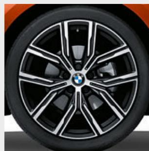
□ Cerchi in lega leggera da 19", styling a Y n° 783 in Jet Black bicolore con pneumatici misti runflat, torniti a specchio, anteriori 8J x 19 con pneumatici 225/40 R19, posteriori 8,5J x 19 con pneumatici 255/35 R19.\*
