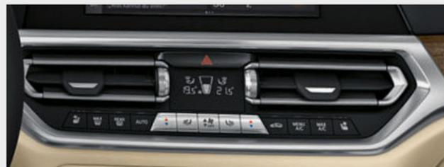
□ Il climatizzatore automatico a tre zone con controllo automatico della temperatura ha comandi separati per il guidatore e il passeggero anteriore e il passeggeri dei sedili posteriori. Sono inclusi il controllo automatico del ricircolo dell'aria (AUC), un microfiltro a carboni attivi, un sensore solare e antiappannamento e bocchette di aerazione posteriori con un display digitale.
