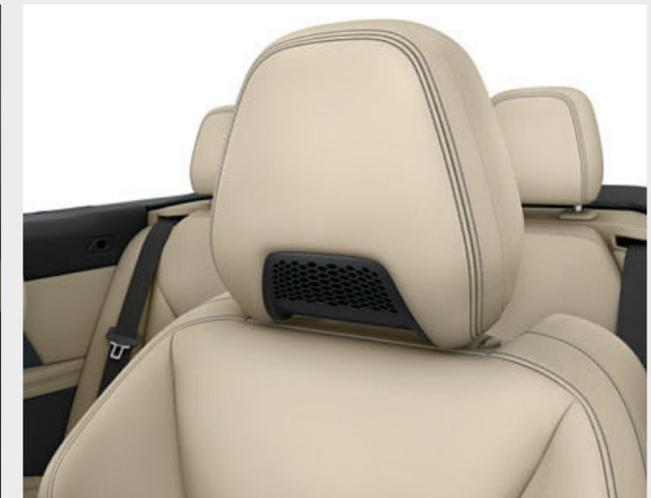
□ L'Air Collar offre viaggi nel massimo comfort, grazie al riscaldamento di testa e spalle. Con la capote aperta, il sistema di aria calda integrato nei poggiatesta dei sedili anteriori viene controllato automaticamente in base alla velocità e alla temperatura esterna. Inoltre, è possibile regolare la temperatura su tre livelli in base alle proprie esigenze.
