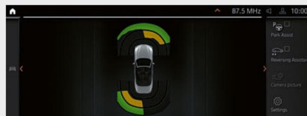
□ Il Parking Assistant<sup>2</sup> facilita le manovre di parcheggio della vettura. La telecamera per retromarcia migliora la visuale posteriore. L'Active Park Distance Control offre un'ulteriore protezione dai danni da parcheggio. Il Parking Assistant parcheggia automaticamente la vettura in senso parallelo o trasversale alla corsia di marcia e la fa uscire dai parcheggi. Il dispositivo di assistenza alla guida in retromarcia vi supporta nelle manovre in retromarcia, ad esempio nelle strettoie.
