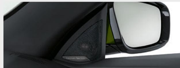
□ L'eccezionale Harman Kardon Surround Sound System è dotato di un amplificatore digitale da 408 W, nove canali e 12 altoparlanti. Le caratteristiche acustiche di questo sofisticato sistema diffondono un suono di eccezionale purezza e di massima qualità nell'abitacolo. L'equalizzazione specifica per la vettura in funzione della velocità compensa tutti i rumori di sottofondo.
