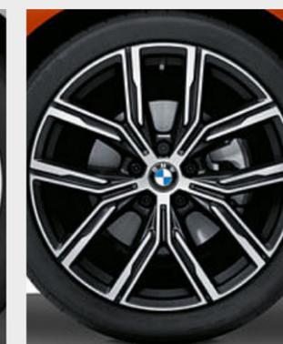
□ Cerchi in lega leggera da 19", styling a Y n° 783 in Jet Black bicolore con pneumatici misti runflat, torniti a specchio, anteriori 8J x 19 con pneumatici 225/40 R19, posteriori 8,5J x 19 con pneumatici 255/35 R19.
