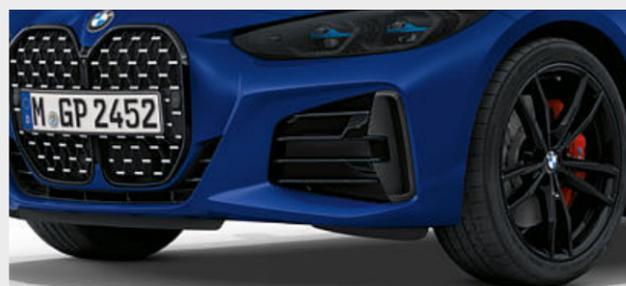
□ Il pacchetto esterni M<sup>3</sup> in carbonio sottolinea il look sportivo della vettura. Gli elementi aerodinamici nel paraurti anteriore e le calotte dei retrovisori esterni sono in materiale sintetico rinforzato in fibra di carbonio (CFRP). Il pacchetto è completato da un inserto del diffusore nella parte posteriore.
