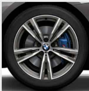
□ Cerchi in lega leggera M da 18", styling a doppi raggi n° 798 M bicolore in Ferric Grey torniti a specchio con pneumatici misti: anteriori 8J x 18 con pneumatici 225/45 ZR18, posteriori 9J x 18 con pneumatici 255/40 ZR18.<sup>1,6</sup>
