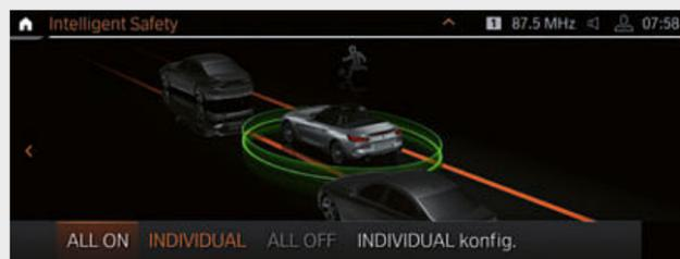
□ Il pacchetto Driving Assistant<sup>5,7</sup> include i seguenti sistemi di sicurezza attiva: Avvertimento di presenza pedoni e rischio di tamponamento con funzione di frenata City, Speed Limit Info con indicatore di divieto di sorpasso e l'Avvisatore di cambio accidentale della corsia di marcia. Include inoltre l'Avvertimento di traffico trasversale posteriore, il Segnalatore di presenza veicoli nei punti ciechi e l'Avvertimento di collisione posteriore.
