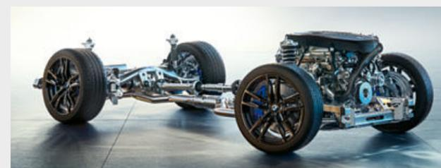
□ L'Assetto Sportivo Adattivo M<sup>2</sup> regola elettronicamente le sospensioni per adeguarsi in ogni momento alle condizioni della strada e della guida. Tramite il Selettore del feeling di guida, il conducente può regolare le sospensioni impostando lo stile di guida preferito, più orientato al comfort o estremamente sportivo con un handling marcatamente dinamico.
