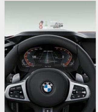
□ Il BMW Head-Up Display<sup>6</sup> a colori visualizza le informazioni rilevanti per la guida nel campo visivo del conducente.
