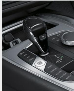
□ Il cambio automatico Steptronic sportivo a 8 rapporti<sup>3,4</sup> consente cambiate molto sportive sia in automatico che manualmente con i paddle sul volante o con la leva selettiva.
