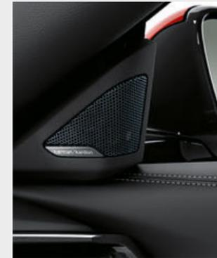
□ L'Harman Kardon Surround Sound System<sup>5</sup> è dotato di amplificatore digitale da 408 watt, sette canali, equalizzatore specifico per la vettura e dodici altoparlanti.
