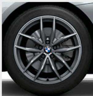
□ Cerchi in lega leggera da 18", styling a V n° 770 in Ferric Grey con pneumatici misti: anteriori 8J x 18 con pneumatici 225/45 ZR18, posteriori 9J x 18 con pneumatici 255/40 ZR18.<sup>1</sup>
