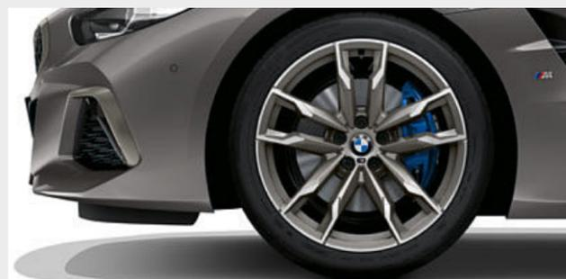
□ Cerchi in lega leggera M da 19", styling a doppi raggi n° 800 M bicolore in Cerium Grey opaco torniti a specchio, con pneumatici misti: anteriori 9J x 19 con pneumatici 255/35 ZR19, posteriori 10J x 19 con pneumatici 275/35 ZR19.<sup>5</sup>
