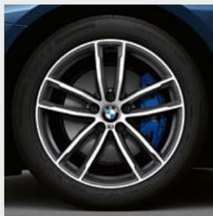
□ Cerchi in lega leggera M da 18", styling a doppi raggi n° 662 M in Orbit Grey con pneumatici misti, torniti a specchio, anteriori 8J x 18 con pneumatici 245/45 R18, posteriori 9J x 18 con pneumatici 275/40 R18.<sup>2</sup>
