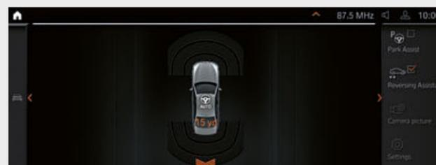
□ Procedendo fino a 35 km/h, l'assistente per la guida in retromarcia\* memorizza gli ultimi 50 m della strada percorsa, per ripercorrerla su richiesta inserendo la retromarcia. Si evita così di agire continuamente sul volante e ci si concentra sul controllo dell'area circostante la vettura.
