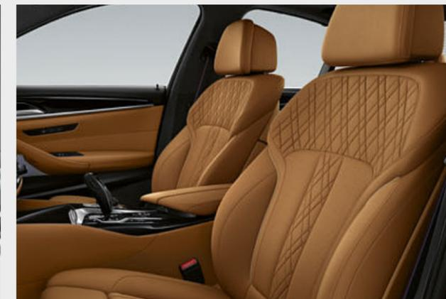
□ I sedili comfort anteriori\* con poggiatesta attivi hanno diverse regolazioni elettriche. Si possono regolare individualmente il segmento superiore dello schienale, la larghezza dello schienale, l'appoggio delle gambe e l'altezza del poggiatesta. L'equipaggiamento comprende il sostegno lombare e la funzione Memory per guidatore e passeggero anteriore.
