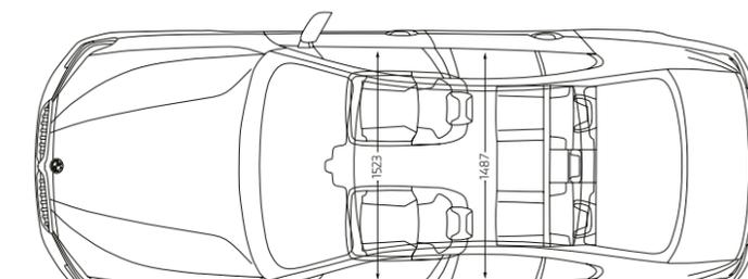
Tutte le misure dei disegni tecnici sono espresse in millimetri. L'altezza senza antenna è di 1466 mm. I dati dimensionali per le vetture M550i xDrive possono essere differenti.
