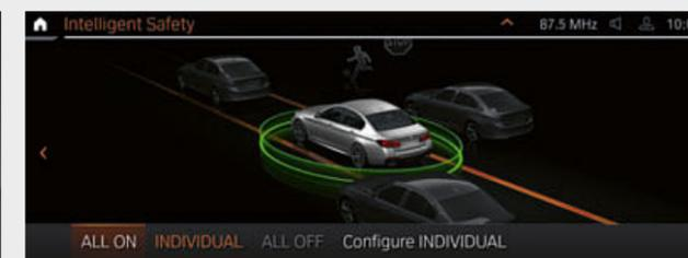
□ Il Driving Assistant Professional<sup>4</sup>\* offre comfort ottimale e sicurezza in situazioni di traffico critiche o monotone. Oltre al contenuto del Driving Assistant, esso comprende, tra l'altro, il dispositivo di assistenza alla sterzata e al mantenimento della corsia con funzionalità estese, il dispositivo di assistenza al cambio di corsia e quello per l'arresto di emergenza, nonché il dispositivo di assistenza al mantenimento della corsia con protezione anticollisione laterale attiva.
