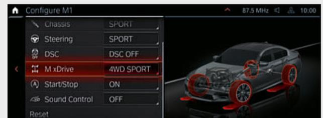
■ Il BMW M xDrive con differenziale attivo M garantisce massima trazione e dinamica di guida sia nella guida quotidiana su strada che nei circuiti. Questa tecnologia specifica M unisce l'agilità tipica della trazione posteriore ai vantaggi della trazione integrale. L'offerta comprende le varianti di trazione 4WD, 4WD Sport e, nella modalità DSC-off, 2WD.
