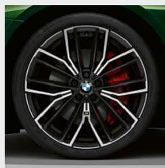
□ Cerchi in lega leggera M da 20", styling a Y n° 846 M in Jet Black bicolore con pneumatici misti runflat, torniti a specchio, anteriori 8J x 20 con pneumatici 245/35 R20, posteriori 9J x 20 con pneumatici 275/30 R20.
