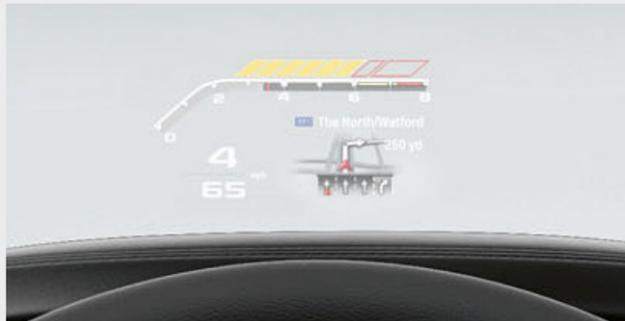
■ Il BMW Head-Up Display<sup>2</sup> multicolorato con grafica specifica M proietta le informazioni rilevanti per la guida direttamente nel campo visivo del guidatore. Premendo un tasto si può attivare la videata specifica M, che indica la marcia innestata, il regime sotto forma di curva dinamica, l'indicatore di cambiata per segnalare il punto ottimale di cambio marcia e le indicazioni di navigazione.
