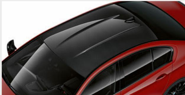
■ Nell'ambito dell'impiego di strutture intelligenti, il tetto in carbonio M contribuisce in modo significativo alla riduzione del peso del veicolo. È costituito da fibra di carbonio (CFRP) ed è più leggero di 800 g rispetto al tetto di serie. Questo abbassa il baricentro della vettura e migliora la dinamica di guida.
