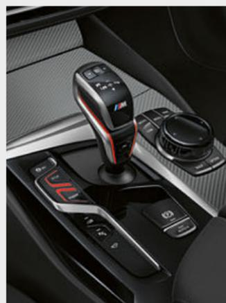
■ Il cambio Steptronic M a 8 rapporti con Drivelogic è caratterizzato da cambiate rapidissime, che si possono effettuare con diverse modalità.
