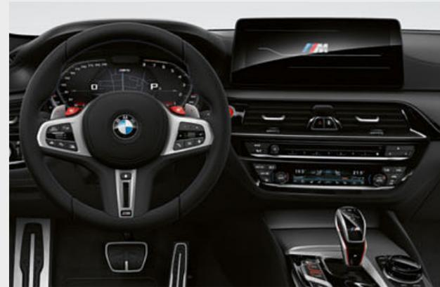
■ Il BMW Live Cockpit Professional con funzione di navigazione include un Control Display ad alta risoluzione da 12,3" con superficie touch e un quadro strumenti con display digitale LCD da 12,3". Il BMW Operating System 7 può essere gestito anche tramite iDrive Touch Controller.
