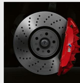
□ Grazie a uno speciale mix di materiali, l'impianto frenante M Compound con pinze freno in rosso lucido permette una perfetta decelerazione, ottima resistenza al fading una durata elevata.
