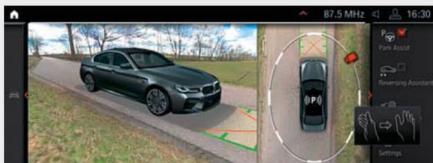
□ Il Parking Assistant Plus facilita le manovre di parcheggio della vettura. Comprende i sistemi Surround View con Top View, Panorama View, Remote 3D View, nonché il dispositivo laterale di assistenza al parcheggio, la funzione di frenata d'emergenza Active Park Distance Control, il dispositivo di assistenza al parcheggio<sup>4</sup> con guida in direzione longitudinale e trasversale e il dispositivo di assistenza alla guida in retromarcia.
