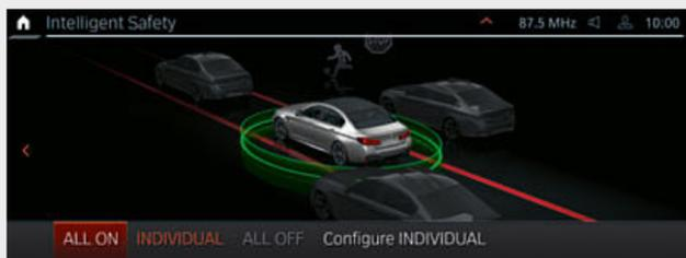
□ Il Driving Assistant Professional<sup>3</sup> offre comfort ottimale e sicurezza in situazioni di traffico critiche o monotone. Oltre al contenuto del Driving Assistant, esso comprende, tra l'altro, il dispositivo di assistenza alla sterzata e al mantenimento della corsia con funzionalità estese, il dispositivo di assistenza al cambio di corsia e quello per l'arresto di emergenza, nonché il dispositivo di assistenza al mantenimento della corsia con protezione anticollisione laterale attiva.
