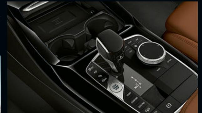
□ Il cambio Steptronic sportivo a 8<sup>3</sup> rapporti consente cambiate molto sportive. Oltre che in automatico, funziona anche manualmente con la leva selettoria o i paddle sul volante, per uno stile di guida orientato al comfort o uno più dinamico. Nella modalità SPORT e con la leva selettoria a sinistra su S/M la gestione degli innesti è impostata in funzione della massima performance.
