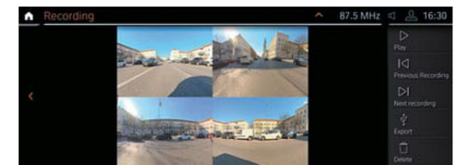
□ Il sistema BMW Drive Recorder, composto da Event e Crash Recorder, consente di registrare un video dell'ambiente circostante la vettura e di visualizzarlo ad esempio sul Control Display oppure di esportarlo sul vostro dispositivo tramite USB. Informazioni importanti sulla vettura, come ad esempio velocità e posizione GPS, vengono salvate sul video.
