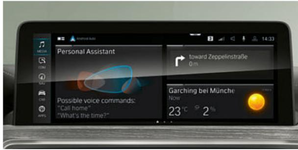
□ Il BMW Live Cockpit Professional con funzione di navigazione include un Control Display ad alta risoluzione da 12,3" con superficie touch e un quadro strumenti con display digitale LCD da 12,3". Il BMW Operating System 7 può essere gestito anche tramite iDrive Touch Controller.
