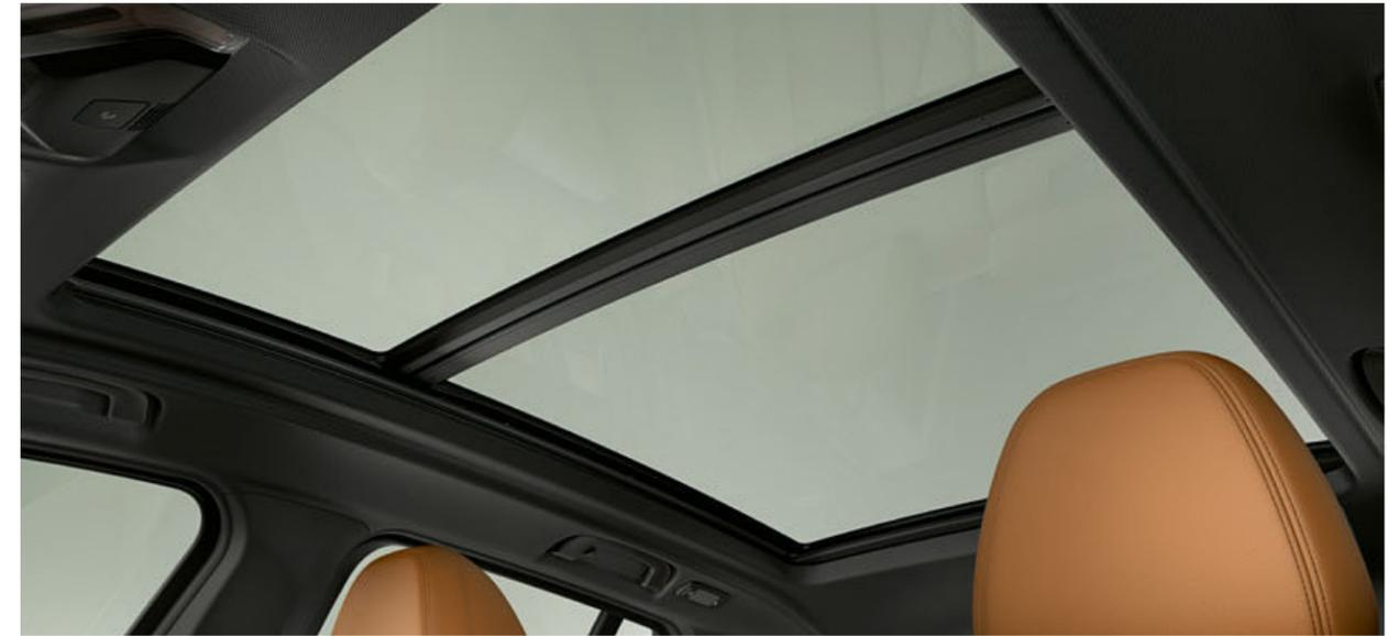
□ Aperto, il tettuccio panoramico in vetro favorisce l'afflusso di aria esterna all'interno dell'abitacolo. Chiuso, crea un'atmosfera luminosa e piacevole. Si apre e si chiude automaticamente con la sola pressione di un pulsante o tramite la chiave della vettura, è scorrevole ed è dotato di tendina parasole avvolgibile e di deflettore antivento.
