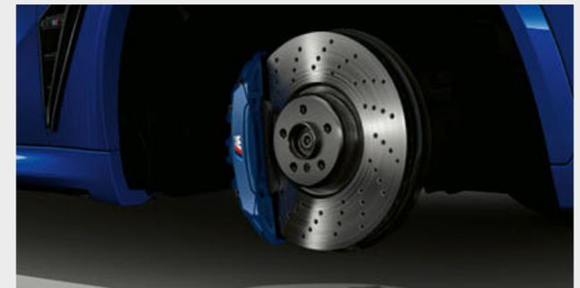
■ Grazie all'impiego di materiali diversi, i freni M Compound oltre a frenare la vettura con grande efficacia, presentano un'elevata resistenza al fading, una durata superiore e consentono una riduzione dei pesi, che influenza positivamente l'agilità, il dinamismo e l'accelerazione. Questo impianto frenante ad alte prestazioni specifico per vetture M è caratterizzato dalle pinze freni in blu metallizzato con il tipico logo M.
