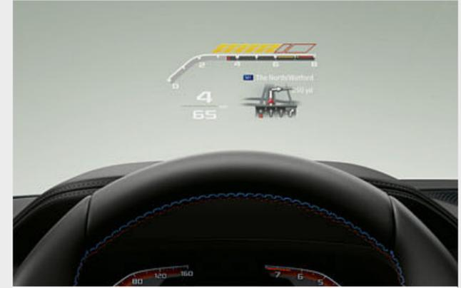
■ Il BMW Head-Up Display<sup>3</sup> \* a colori con visualizzazione specifica per le versioni M proietta tutte le informazioni rilevanti per la guida direttamente nel campo visivo del guidatore, che non deve mai distogliere l'attenzione dal traffico. Vengono visualizzate informazioni come la velocità e, a seconda dell'equipaggiamento, le indicazioni del navigatore, lo Speed Limit Info con indicazione del divieto di sorpasso, la rubrica telefonica e l'elenco dell'entertainment.
