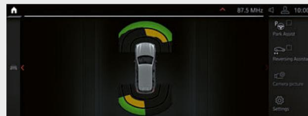
□ Il Parking Assistant Plus facilita le manovre per il parcheggio della vettura. Comprende il sistema Surround View con Top View, Panorama View, Remote 3D View, nonché un assistente laterale per il parcheggio, la funzione di frenata d'emergenza Active Park Distance Control, l'assistente di parcheggio con guida in direzione longitudinale e trasversale e l'assistente per la guida in retromarcia.
