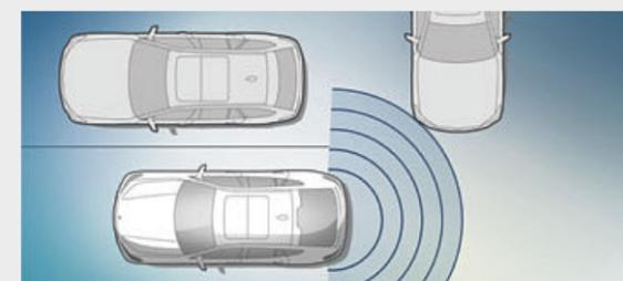
□ L'**Avvertimento di traffico trasversale posteriore\*** aiuta a uscire da un parcheggio trasversale, avvertendovi della presenza di traffico laterale.
