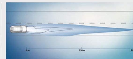
□ **BMW Laserlight** con design specifico X e una profondità massima del raggio luminoso nella modalità abbaglianti fino a 500 m.
