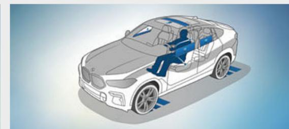
□ **Active Protection** interviene in situazioni critiche e frena la vettura dopo un incidente garantendone l'arresto completo.
