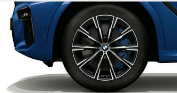
■ Cerchi in lega leggera M da 20", styling a stella n° 740 M in Orbit Grey bicolore con pneumatici misti Run-Flat, torniti a specchio, anteriori 9J x 20 con pneumatici 275/45 R20, posteriori 10,5J x 20 con pneumatici 305/40 R20.
