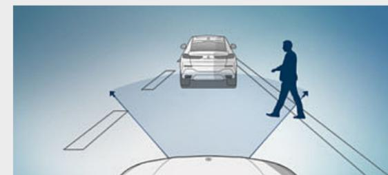
■ **Active Guard\*** include l'avvertimento anticollisione frontale con funzione di frenata e l'avvisatore di cambio accidentale della corsia di marcia.
