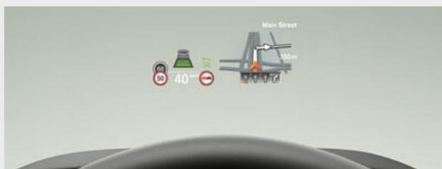
□ Il BMW Head-Up Display<sup>2</sup> a colori visualizza tutte le informazioni rilevanti per la guida direttamente nel vostro campo visivo, permettendovi di concentrarvi completamente sul traffico. Vengono visualizzate informazioni come la velocità, le indicazioni del navigatore, lo Speed Limit Info con indicazione del divieto di sorpasso, la rubrica telefonica e le informazioni dell'entertainment.
