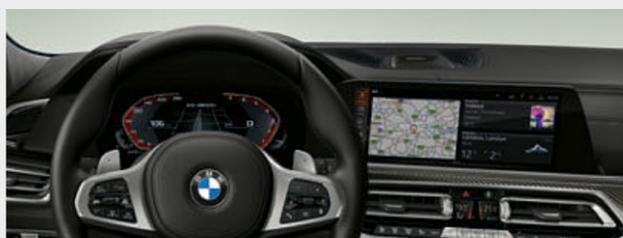
■ Il BMW Live Cockpit Professional con funzione di navigazione<sup>1</sup> include un Control Display ad alta risoluzione da 12,3" con superficie touch e un quadro strumenti con display digitale LCD da 12,3".
