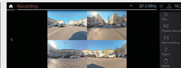
□ Il BMW Drive Recorder\* consente di registrare un video dell'ambiente circostante la vettura e di visualizzarlo ad esempio sul Control Display centrale oppure di esportarlo tramite USB sul vostro dispositivo. Importanti informazioni sulla vettura come ad es. la velocità e la posizione GPS vengono salvate in modo sincrono con il video. Il Drive Recorder ha due funzioni subordinate: event recorder e crash recorder.
