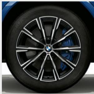
■ Cerchi in lega leggera M da 20", styling a stella n° 740 M in Orbit Grey bicolore con pneumatici misti Run-Flat\*, torniti a specchio, anteriori 9J x 20 con pneumatici 275/45 R20, posteriori 10,5J x 20 con pneumatici 305/40 R20.<sup>2</sup>
