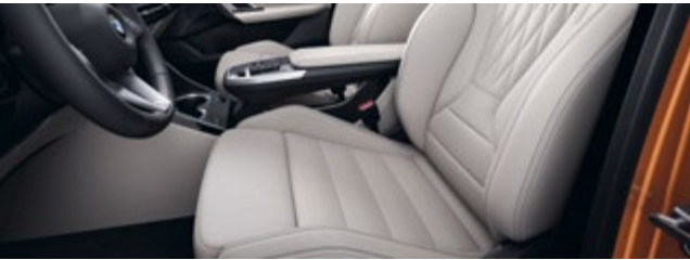
Per un notevole aumento del comfort nei giorni freddi, i riscaldatori dei sedili per il guidatore e il passeggero anteriore riscaldano le superfici del sedile e dello schienale in tre fasi.
