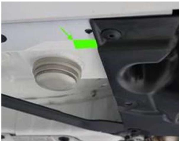
**Fig.2:** Punto di misurazione asse anteriore.
