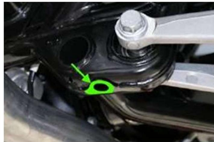
**Fig.3** Punto di misurazione asse posteriore.
