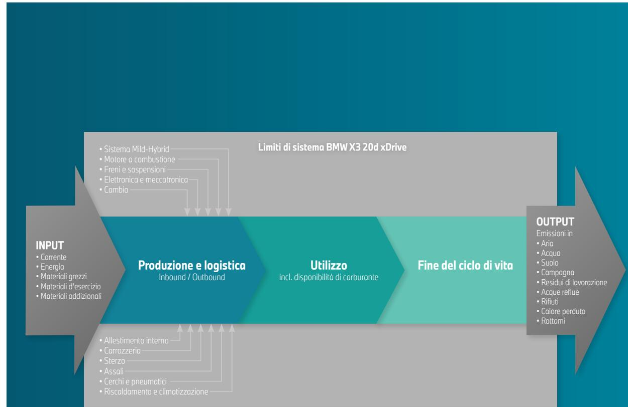
Fig. 1: Limiti di sistema ecobilancio BMW X3 20d xDrive.
